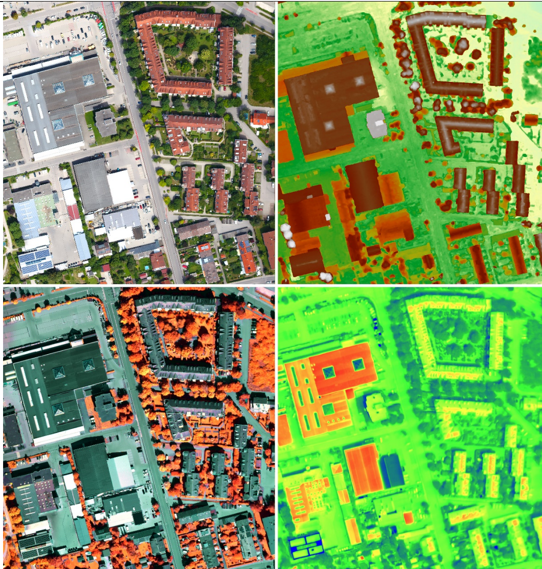
Abb. 1: Aus einem Bildflug können mehrere Luftbildprodukte erzeugt werden: RGB-True Orthofoto (links oben), Oberflächenmodell (rechts oben), Multispektralaufnahme (links unten), Thermalaufnahme (rechts unten) (3D RealityMaps 2022)
