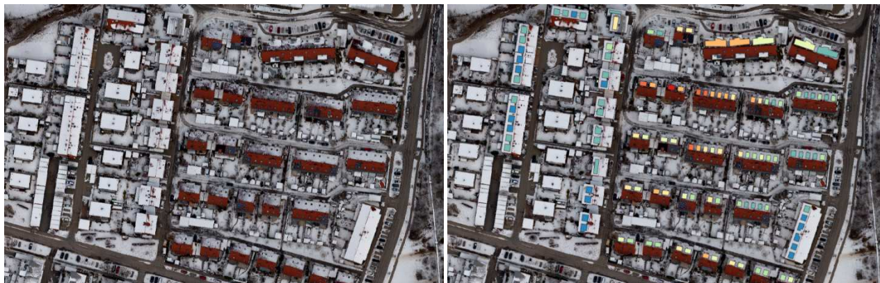
Abb. 4: RGB-Orthofoto aus dem Winter-Bildflug (links) und Überlagerung der Temperaturen an der Dachoberfläche (rechts) (RealityMaps 2023)
