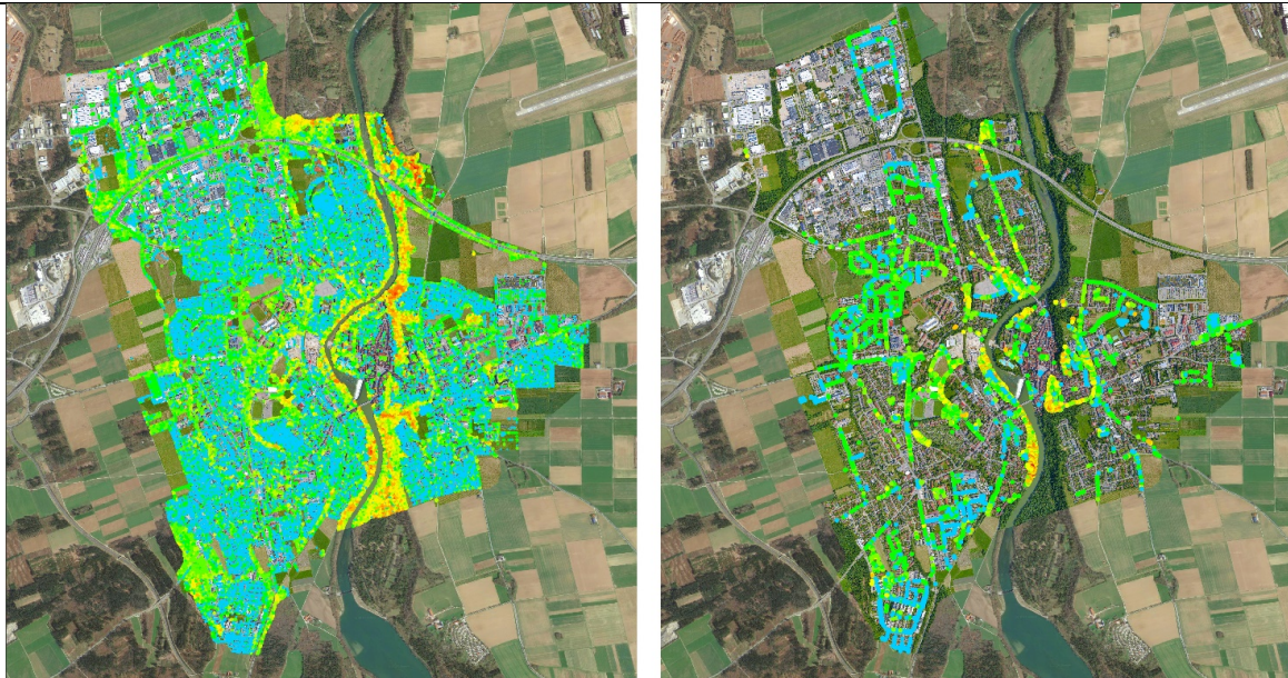
Abb. 8: Per KI-Algorithmus erkannte Bäume (links) vs. im Baumkataster kartierte Bäume (rechts) (RealityMaps 2024)
