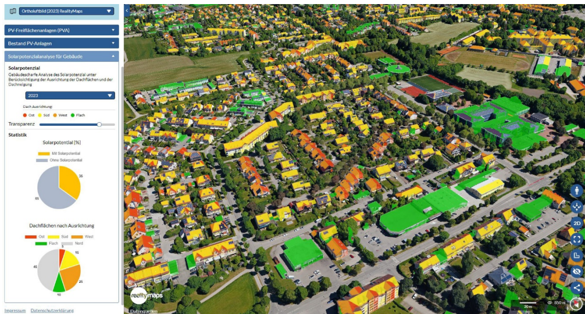
Abb. 7: Auf Basis des virtuellen 3D-Stadtmodells ermitteltes PV-Potenzial, klassifiziert nach Dachausrichtungen (RealityMaps 2023)
